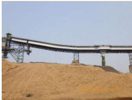
รูปที่ 2-15 การปิดครอบสายพานลำเลียงขานอ้อย
