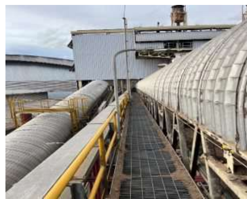
รูปที่ 2-15 การปิดครอบสายพานลำเลียงขานอ้อย
